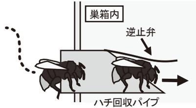
戻ってきた働きバチは、逆止弁を押し上げて巣に入ります。巣箱内の働きバチは、逆止弁があるため、ハチ回収パイプ側から外には出られません。
