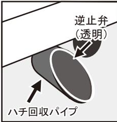
ハチ回収パイプおよび逆止弁の装着位置
