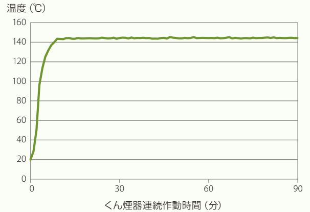
図.アグリ・トップ®硫黄くん煙器の蒸発皿液中温度の推移 (26℃環境下での計測値)
