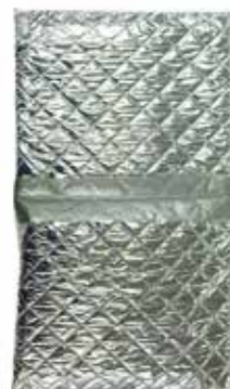
右画像: 袋に収納する際の潜熱蓄熱材の形状 (アルミ蒸着バッグに入れ、連結させて袋に収納しています)
