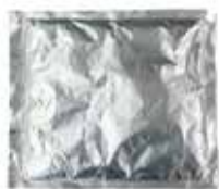
左画像：アルミ袋に封入した潜熱蓄熱材の外観(1パック)
