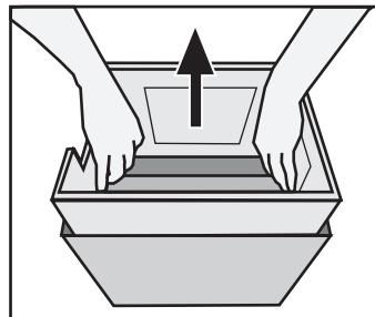
③断熱材を半分程度引き上げ、断熱材の切込みに沿って窓部分(4箇所:斜線部分)を外します。
