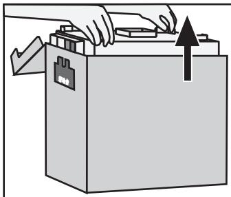
②断熱材の下側に手をかけ、断熱材を引き上げます。
