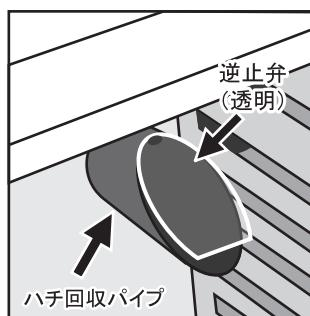
ハチ回収パイプおよび逆止弁の装着位置
