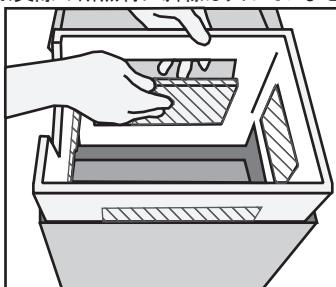
断熱材を引き出して窓部分(4箇所:斜線部分)を外すこともできます。
