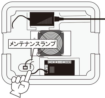
②電源スイッチをオフ（OFF）にした後、ファンの完全停止を確認し、電源プラグをコンセントから抜いた直後に機械ユニットを持ち上げて、温度制御ユニットの庫内側ファンカバーを手で触ってください。
