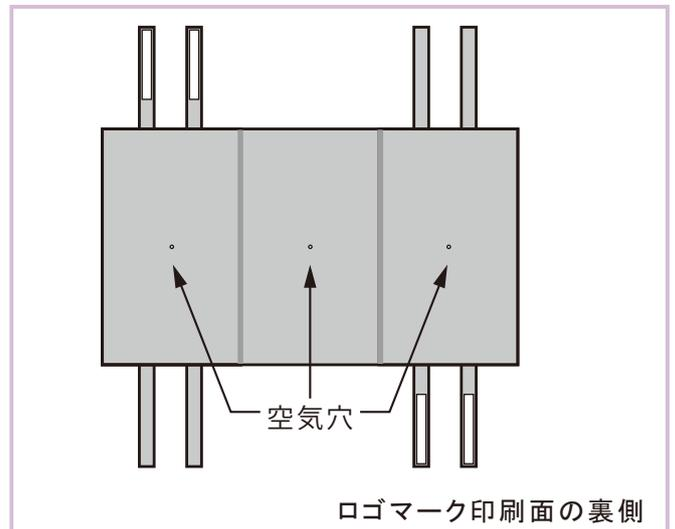
ロゴマーク印刷面の裏側には、膨張防止のために小さな空気穴が設けてあります。
